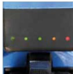
Сверление с оптимальной скоростью, благодаря индикатору контроля мощности
