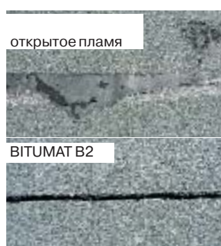
Открытое пламя BITUMAT B2 Однозначно лучший результат по сравнению со сваркой открытым пламенем.
