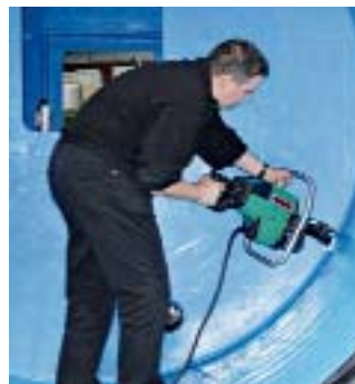
Ручной экструдер WELDPLAST S6 легко направляется при помощи практичной рукоятки.
