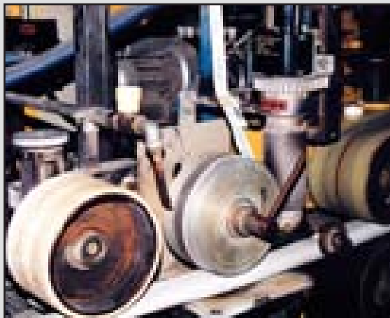
Нагреватели 5000 при сварке бесконечного шланга и ПВХ.
