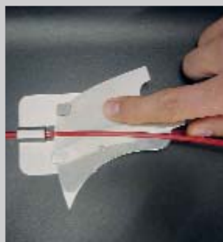
Шаг 3: предварительная подрезка шнура после сварки.
