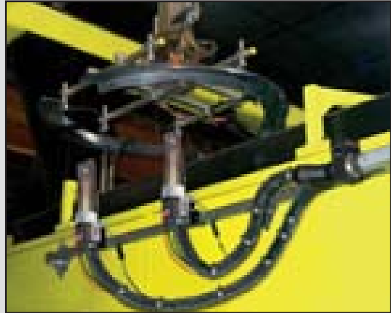
Поток горячего воздуха удаляет грат с пластмассовых деталей после формования.
